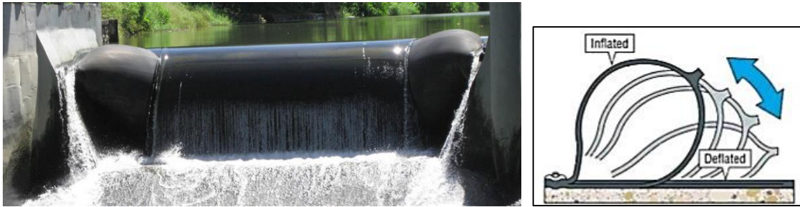
圖 3.1-3 橡皮壩圍堰示意圖
